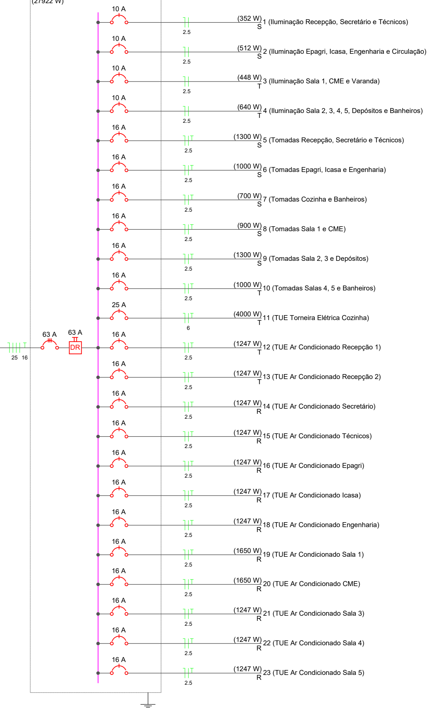
QD1 (Quadro de Distribuição 1º Pavimento)
