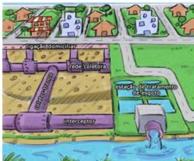
Figura 3 – Sistema de Esgotamento Sanitário
